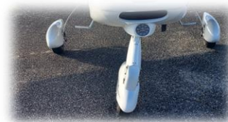
Train avant partiellement rompu
