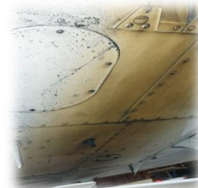
Traces de graisse sous l'avion
